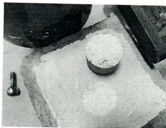
Фото 2. Характер отрыва когезионный по телу образца
